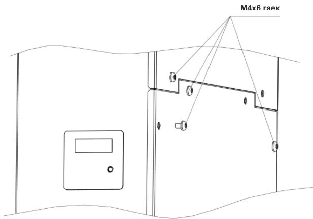
2. Для снятия защитного кожуха лампы открутите 4 M4x6 зубчатых гаек
